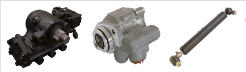
Schauen wir uns die wichtigsten Themen rund um das Lenksystem (Lenkgetriebe, Lenkzylinder und Servopumpe) eines Nutzfahrzeuges einmal näher an.
